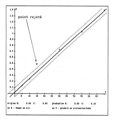
Sur la portion retenue, une régression de type y=ax est effectuée, la détermination automatique de a permet de connaître la vitesse initiale de l'apparition du produit P (on obtient a=0.024). Il est possible également de rappeler l'ensemble des points expérimentaux du nuage initial pour obtenir le graphique suivant qui conclut la première étude.
