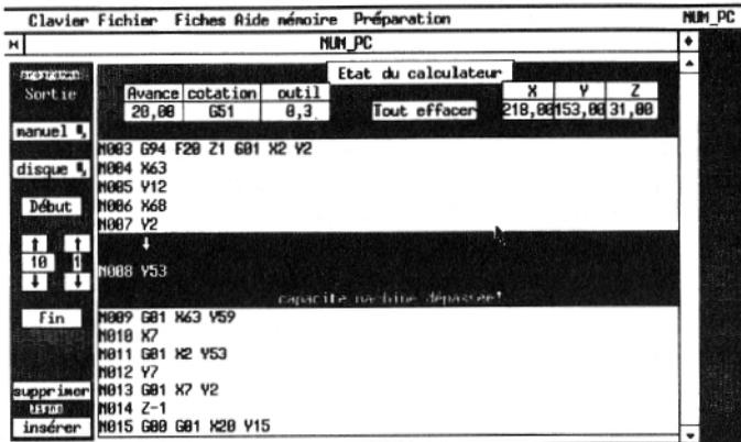
b - basé sur un principe conversationnel et une génération semi-automatique de programmes, il constitue donc une aide à la programmation permettant de tester des parties de programmes et un instrument didactique simple à utiliser.
