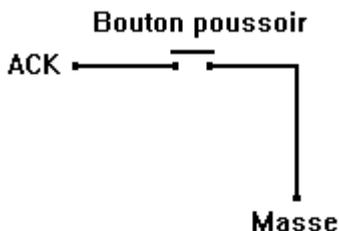
A l'état de repos, ACK est à l'état haut. Un appui sur le bouton relie ACK à la masse et donne donc un 0 qui est détecté. Le programme suivant devrait donc permettre l'allumage des leds comme désiré.
