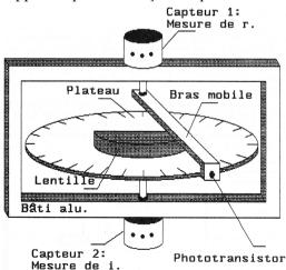
La mesure des angles est réalisée par deux "capteurs de déplacement" rotatifs. Ces composants sont très utilisés dans l'industrie pour les machines outils. Ce sont en fait des potentio mètres de grande précision. Ils sont en général très coûteux. Un modèle à moins de 300 francs pièce à pu être trouvé dans la mesure où, pour cette application, un montage sur roulement à billes n'est pas nécessaire, la linéarité étant la qualité primordiale.
