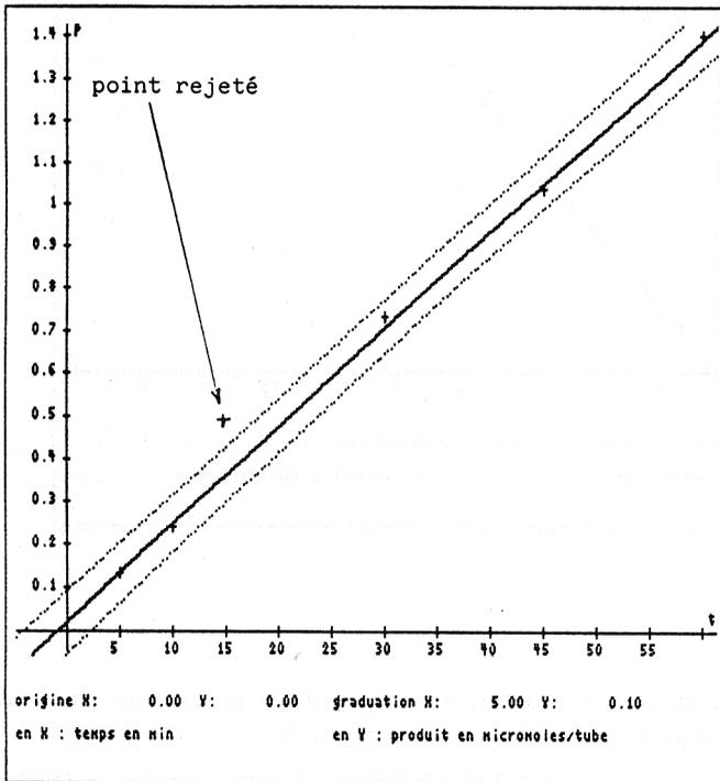
Sur la portion retenue, une régression de type  $y=ax$  est effectuée, la détermination automatique de  $a$  permet de connaître la vitesse initiale de l'apparition du produit  $P$  (on obtient  $a=0.024$ ). Il est possible également de rappeler l'ensemble des points expérimentaux du nuage initial pour obtenir le graphique suivant qui conclut la première étude.
