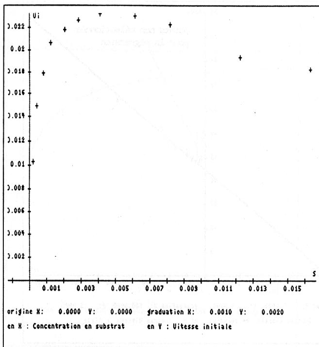
Bien qu'il soit possible d'expérimenter divers modèles avec REGRELIN, c'est généralement la connaissance théorique préalable du modèle (ici  $1/v_i = a/S + b$ ) qui permet d'exécuter la bonne transformation parmi toutes celles proposées par le logiciel.
